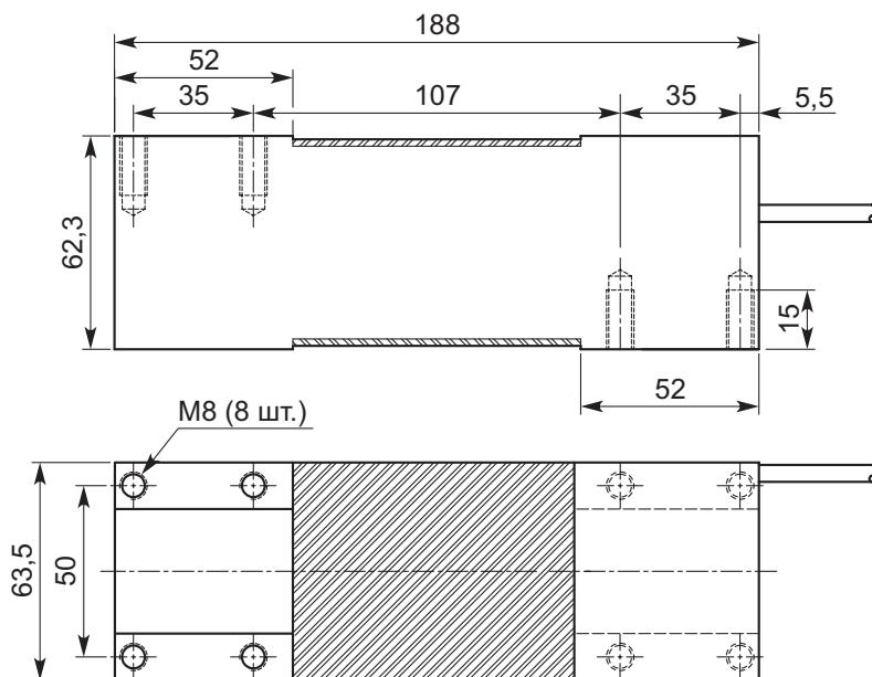
Монтажные винты M8 8.8; момент затяжки 25 Нм. Резьбовое соединение перед монтажом смазать.
