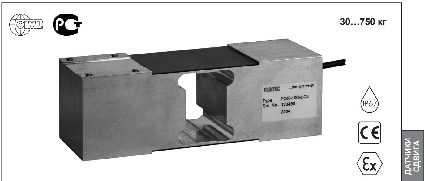
Тензометрический датчик на сдвиг серии PC60 технологии SINGLE POINT минимизирует действие паразитных нагрузок и боковых смещений. Датчик изготовлен из алюминия. Полимерная заливка измерительных элементов обеспечивает высокий класс защиты (IP67).
