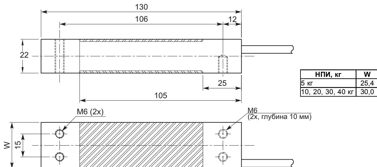
Монтажные болты М6 8.8; момент затяжки 10 Нм. Резьбовое соединение перед монтажом смазать.
