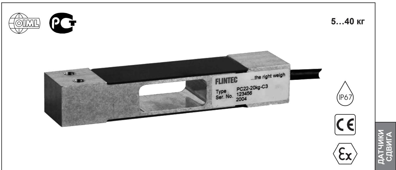
Тензометрический датчик на сдвиг серии PC22 технологии SINGLE POINT минимизирует действие паразитных нагрузок и боковых смещений. Датчик изготовлен из алюминия. Полимерная заливка измерительных элементов обеспечивает высокий класс защиты (IP67).
