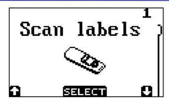
• На экране терминала появляется надпись Scan barcode. В этот момент можете сканировать штрих-код с помощью нажатия кнопки для сканирования или ввести штрих-код вручную с цифровой клавиатуры устройства. Для ввода букв в штрих-код удерживайте нажатой клавишу "SHIFT", пока нажимаете кнопки на цифровой клавиатуре. Для завершения ввода нажмите "ENT" или "SCAN".
